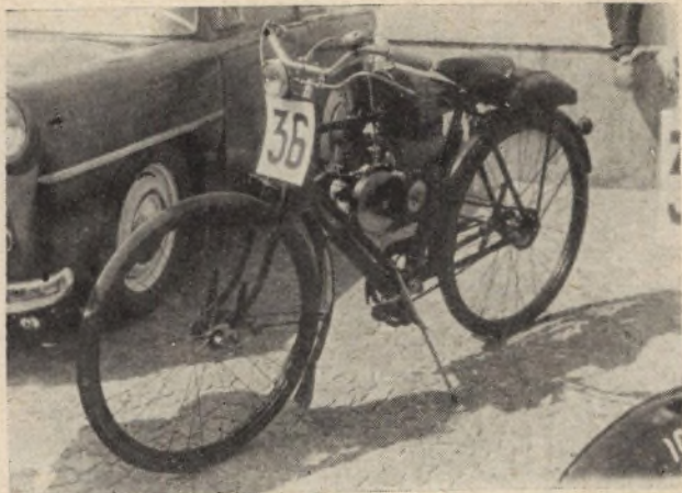
Zmotoryzowany rower, wykonany przez Wacława Kobusa z Lublina. Własna konstrukcja silnika i zawieszenia na wahaczach przedniego koła
