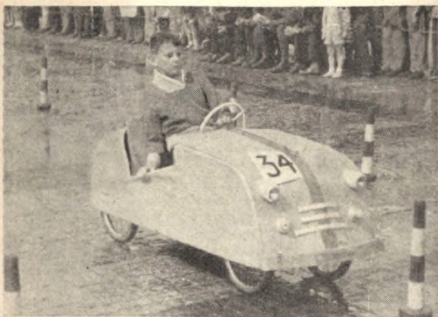
Samochodzik dziecinny wykonany przez Jerzego Reszla. Silnik elektryczny 100 W zasilany z akumulatora 12 V, który wystarcza na 6 godzin jazdy
